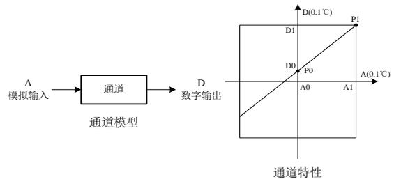
设置通道特性的目的是为了调整模块的现场线性误差, 由于模块的使用的环境温度的不同及使用补偿电缆 (连接电缆) 的原因, 会给测量结果带来误差, 用户可以通过设定通道特性来消除此类误差。
