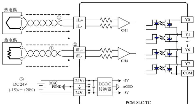
图中的①~⑥表示布线时必须注意的 6 个方面：
